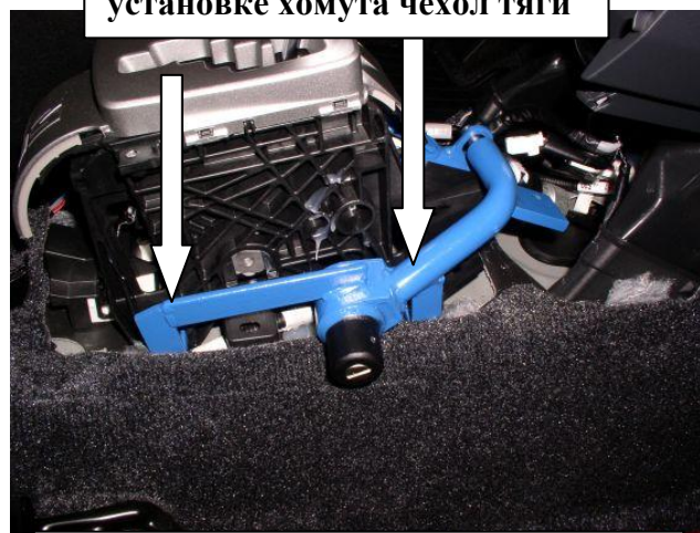
Установить замок на селектор, зафиксировать 2 срывными болтами
