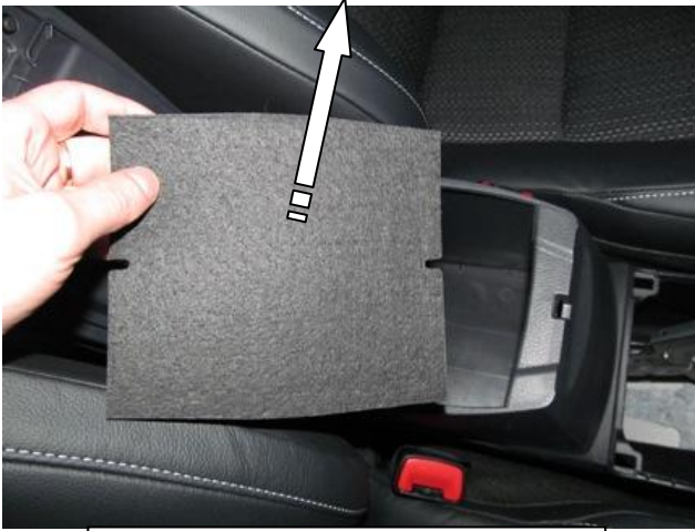
Поднять подлокотник, снять декоративную прокладку
