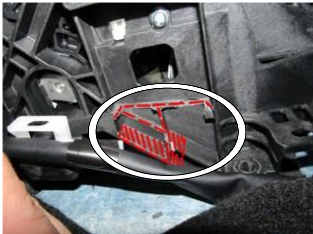
Удалить мешающий установке замка пластик селектора
