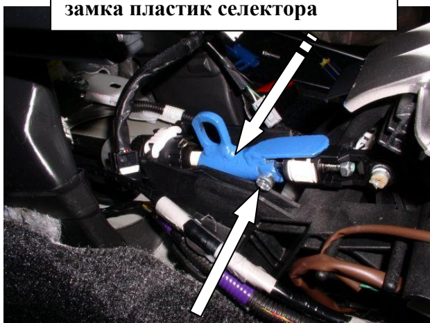
Установить хомут на тягу, зафиксировать винтом (не срывать!!!)
