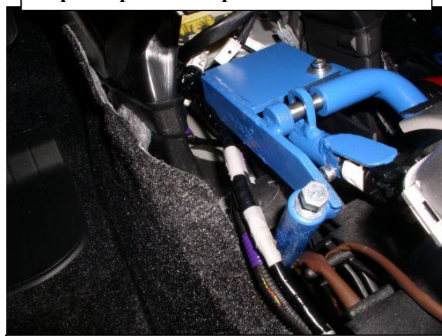
Перевести рычаг переключения передач в положение «Р», произвести блокировку, отрегулировать положение хомута на тяге, сорвать винт.
