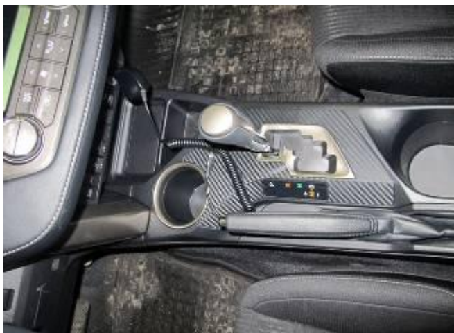
1 Положение рукоятки рычага переключения передач в положении для блокировки
