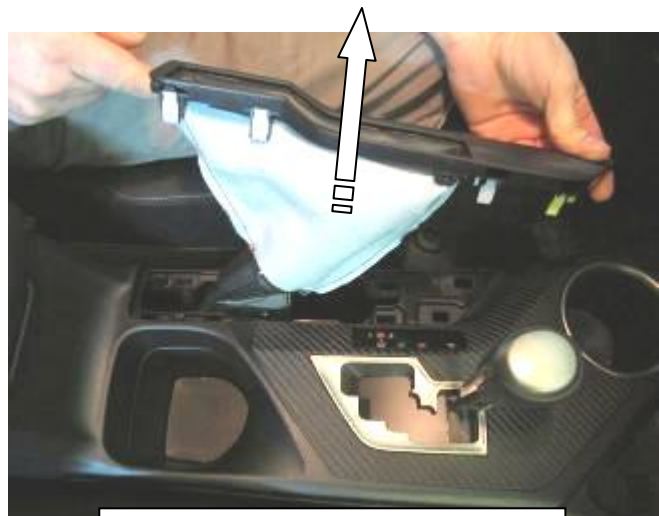
2 Снять декоративный чехол рычага стояночного тормоза
