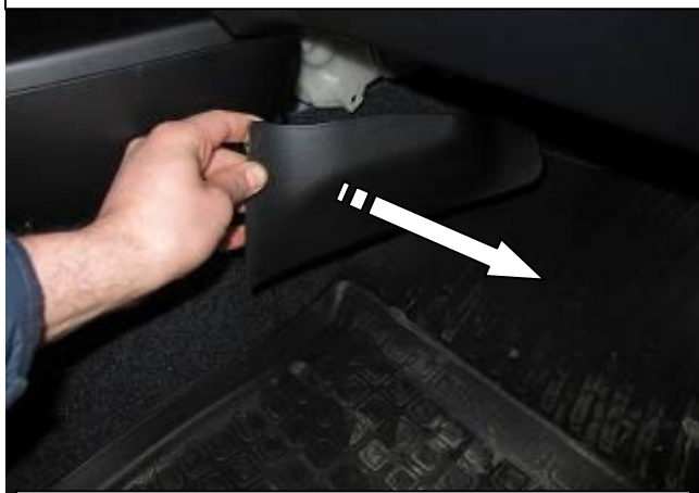
3 Снять боковые крышки с обеих сторон
