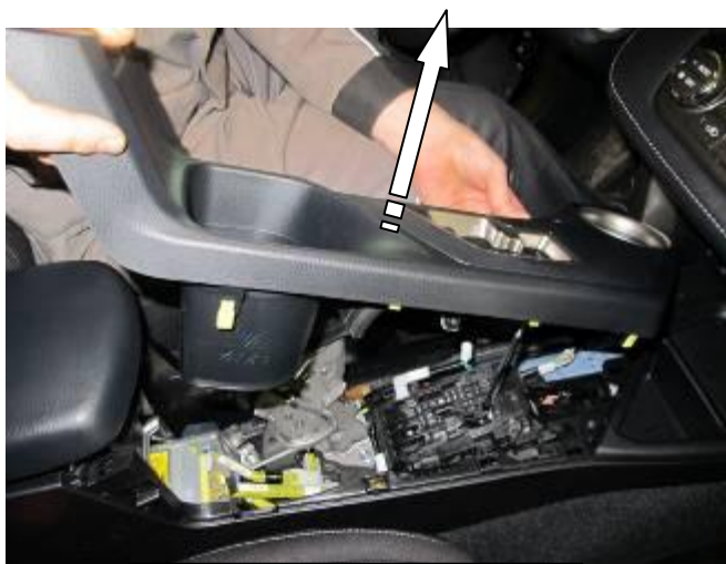
5 Снять верхнюю крышку
