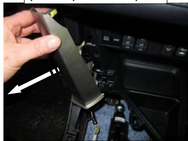
6 Снять декоративную планку
