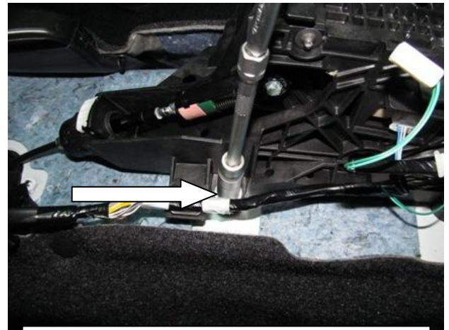
Открутить штатный болт селектора
