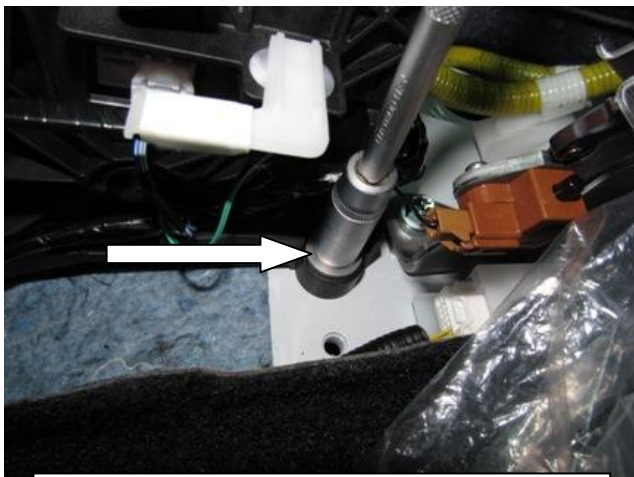
Открутить штатный болт селектора
