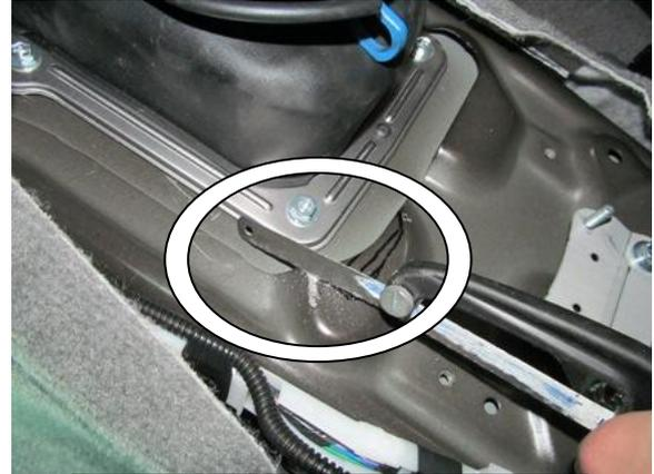
Удалить пластик селектора, мешающий установке замка
