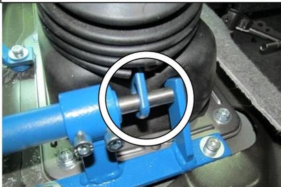
Перевести рычаг переключения передач в положение «R», произвести блокировку, отрегулировать положение хомута на рычаге, зафиксировать хомут 2 срывными болтами
