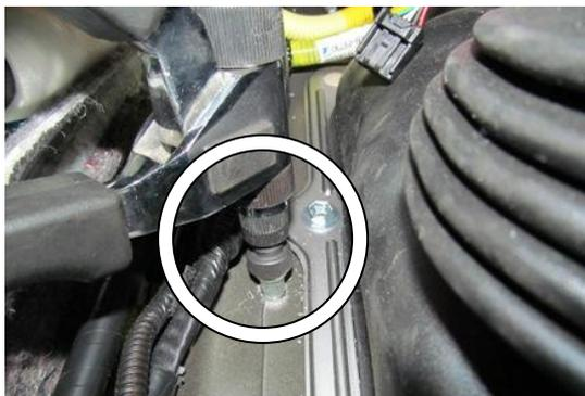
Снять замок и кронштейн, просверлить 3 крепёжных отверстия 9 мм. по разметке, установить резьбовые заклёпки в крепёжные отверстия, используя клёпальник
