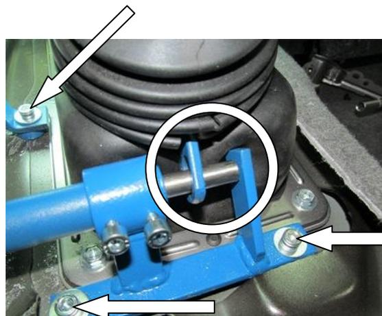
Повторно установить замок и кронштейн на столбики, зафиксировать 3 срывными болтами на днище
