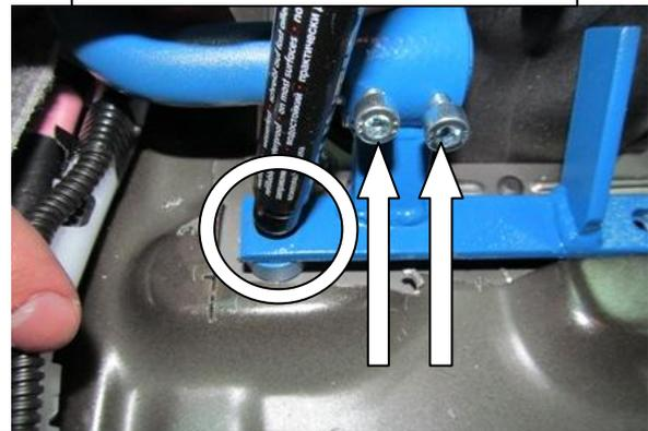
Установить замок трубой в кронштейн замка, зафиксировать 2 винтами, установить замок и кронштейн на столбики, разметить точки сверления дна по отверстиям замка
