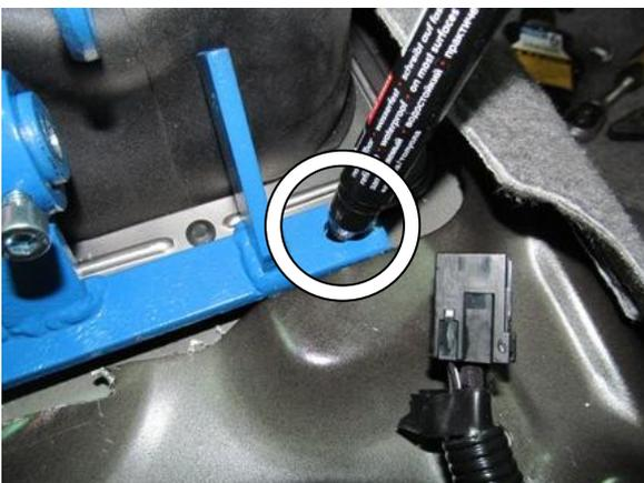
Разметить точки сверления дна по отверстиям замка
