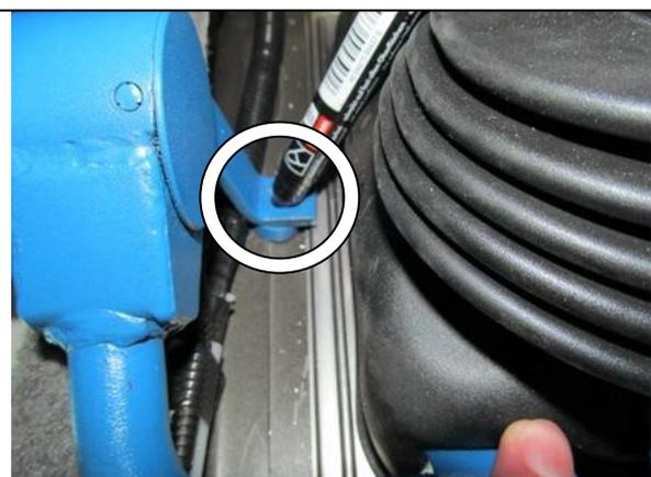
Разметить точки сверления дна по отверстиям замка
