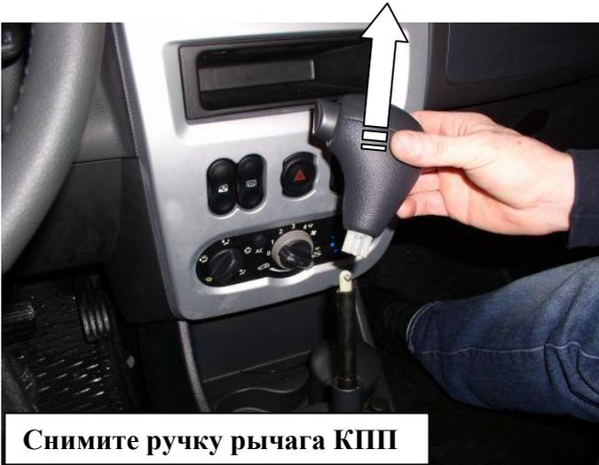
Снимите ручку рычага КПП
