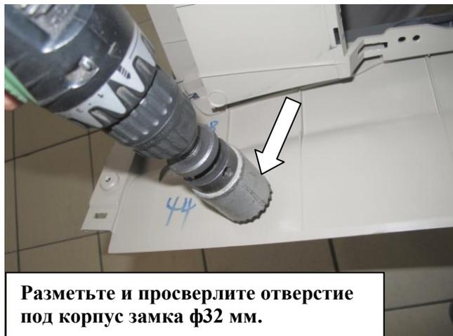
**Разметьте и просверлите отверстие под корпус замка  $\phi$ 32 мм.**
