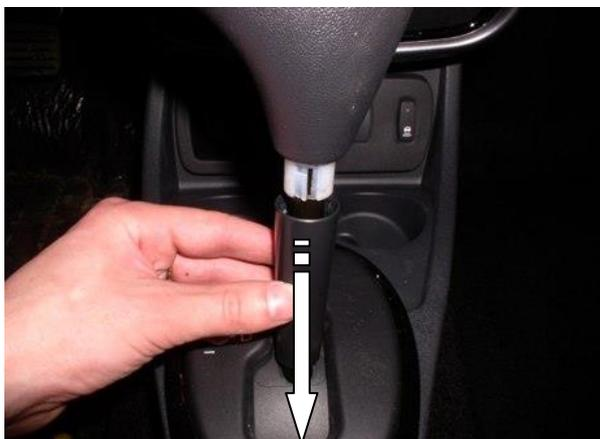
Снять декоративный колпак рукоятки рычага переключения передач
