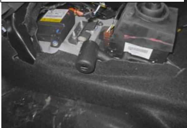
Перевести рычаг переключения передач в положение «Р», произвести и проверить блокировку, сорвать болты
