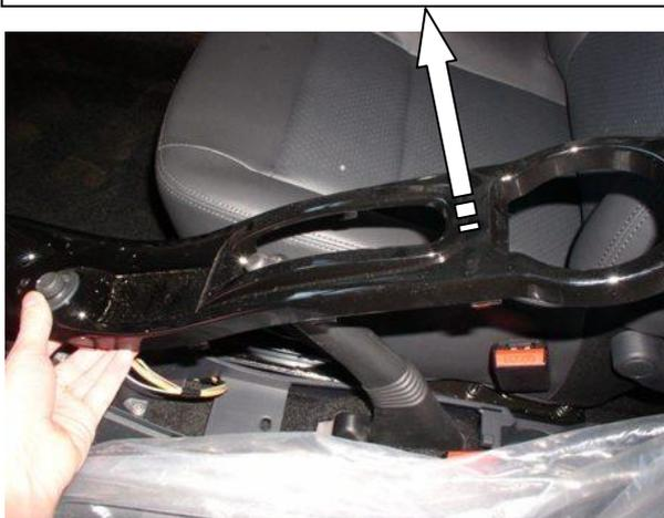
Снять декоративную панель
