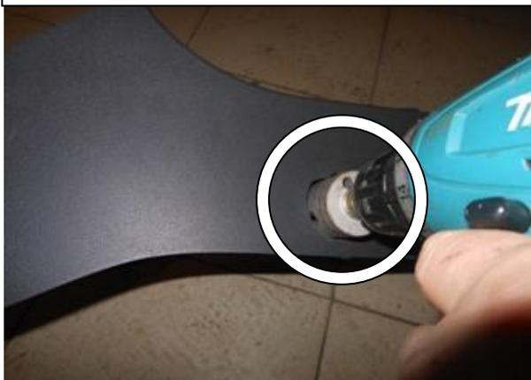
Просверлить отверстие и расширить до 32 мм.
