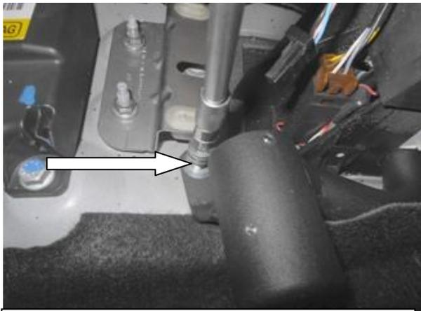
Открутить 2 штатных болта селектора, установить замок трубой в отверстие, закрутить срывной болт
