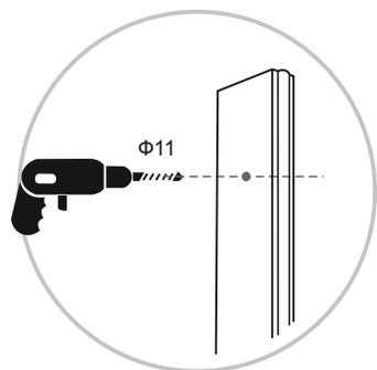
**!** отверстия, в стойках сверлим на высоте, удобной для пользования турником!
