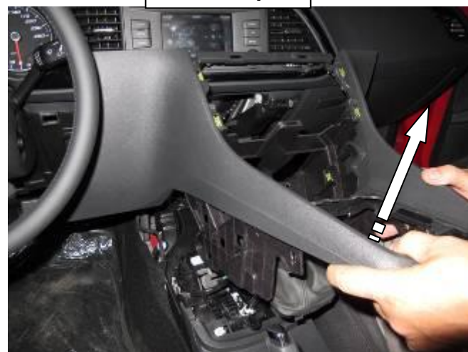
Снять верхнюю консоль
