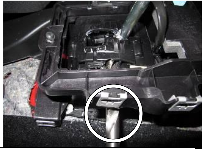
20 Просверлить отверстие 12 мм. в пластиковой детали рычага переключения передач
