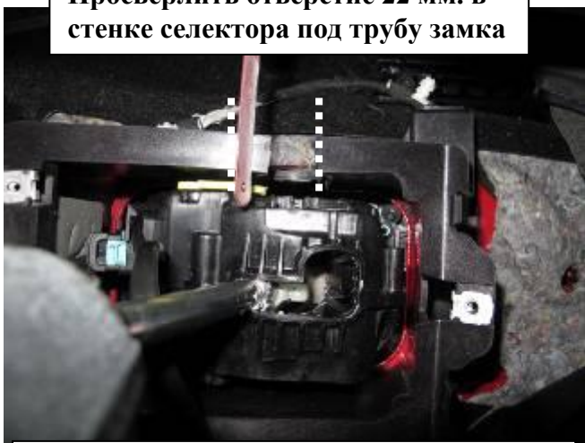
21 Удалить мешающий пластик селектора
