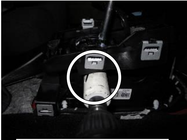
19 Просверлить отверстие 22 мм. в стенке селектора под трубу замка
