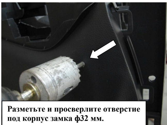
Удалите часть пластика консоли упирающегося в замок
