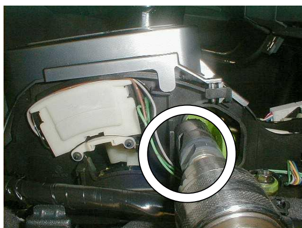
Просверлить отверстие в селекторе под трубу замка
