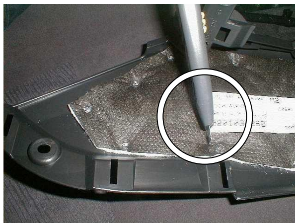
Удалить мешающую установке замка звукоизоляцию
