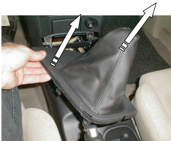
Открутить и снять рукоятку рычага переключения передач, снять декоративный чехол рычага
