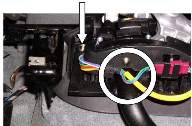
Просверлить отверстие в селекторе под корпус замка, установить замок, закрутить 2 болта
