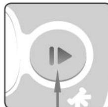
Для блокировки звуковых сигналов однократно при включении аппарата нажмите кнопку запуска программ, одновременно поворачивая ключ.
