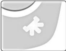
Индикатор состояния ресурса лампы высвечивается желтым, если до выработки ресурса лампы остается 300 вспышек.
