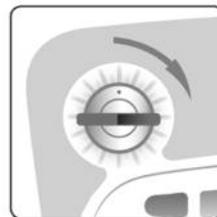
Вставьте ключ в замок и поверните по часовой стрелке для разблокировки аппарата. Световой индикатор вокруг замка начнет мигать зеленым и раздастся 3 звуковых сигнала. При разблокировке аппарата по умолчанию устанавливается минимальный уровень интенсивности воздействия (1). При включении аппарата начинает работать встроенный вентилятор.
