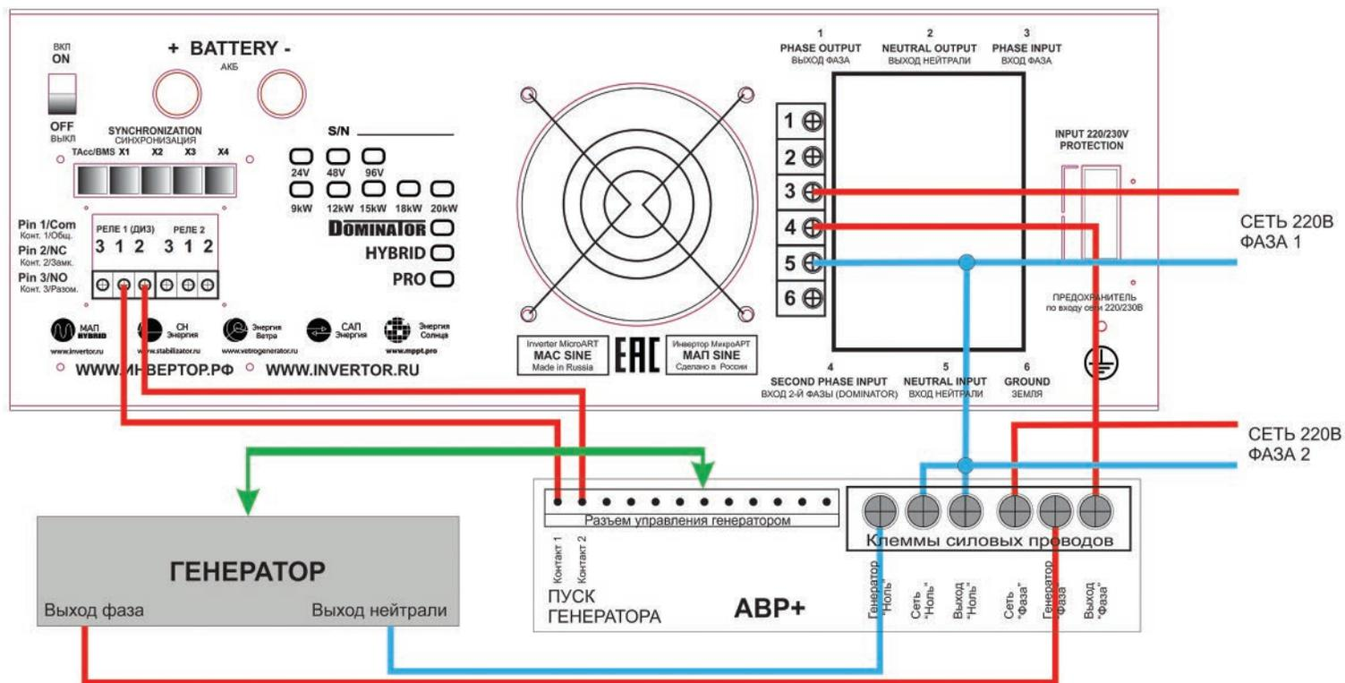
Рисунок 14. Пример подключения Бензо/Газо/Дизель генератора на 2-й вход МАП DOMINATOR с помощью АВР+
