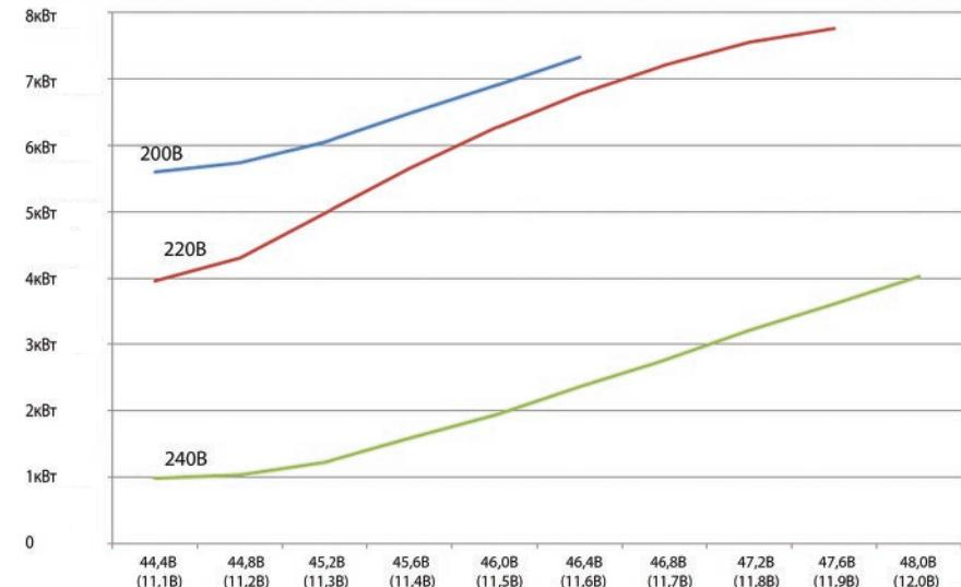
Рисунок 7. Зависимость максимально возможной подкачки от напряжения на АКБ и напряжения в сети.
