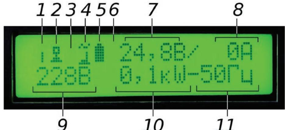
Рисунок 6. Индикация на ЖКИ
