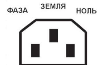
Рисунок 4. Вход сети приборов мощностью до 3 кВт
