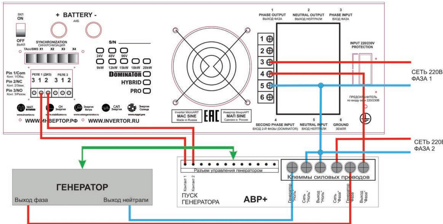
Рисунок 14. Пример подключения
