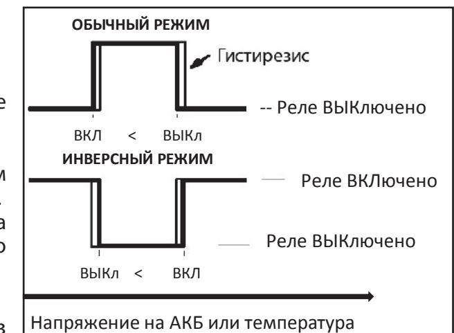
Рисунок 11. Режимы работы Реле
