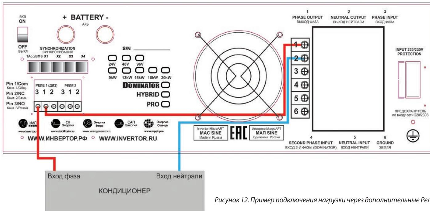
Рисунок 12. Пример подключения нагрузки через дополнительные Реле
