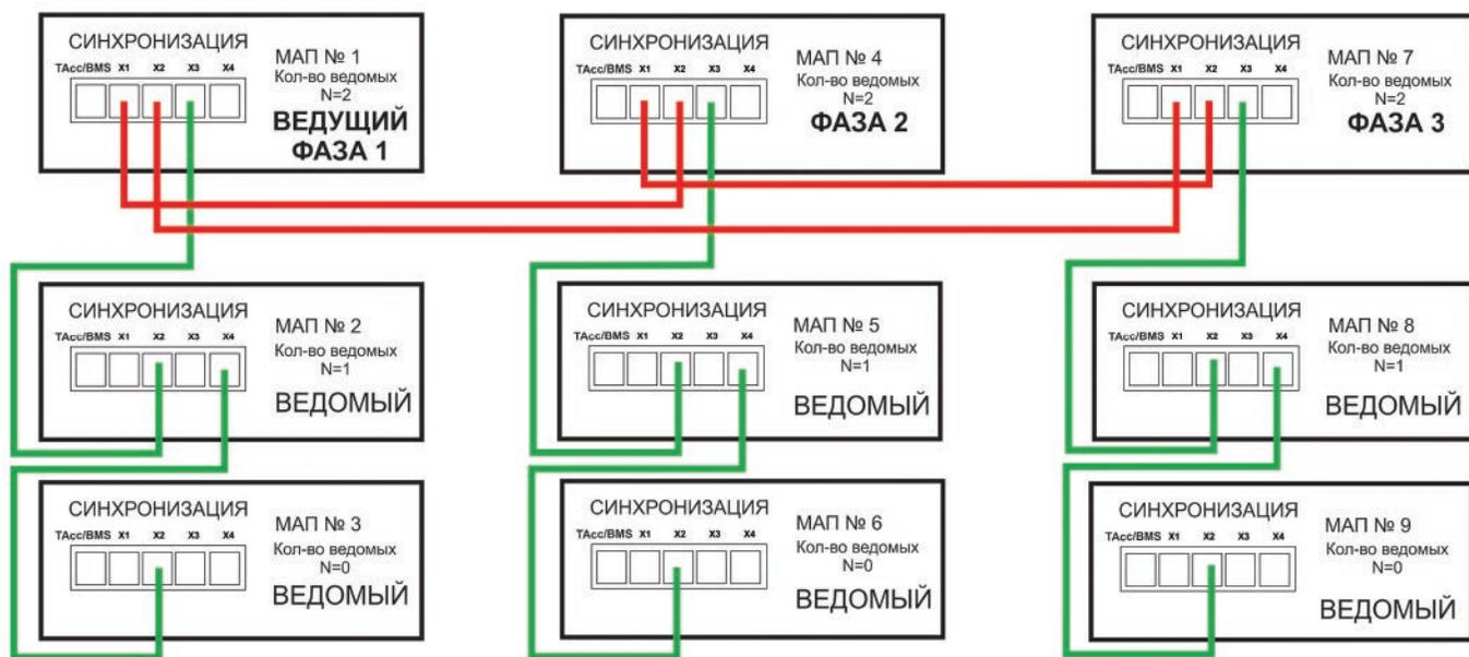
Рисунок 9. Схема синхронизации в трехфазной сети, пример на 9 приборах
