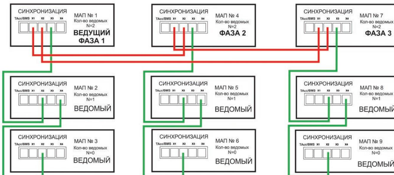
Рисунок 9. Схема синхронизации
