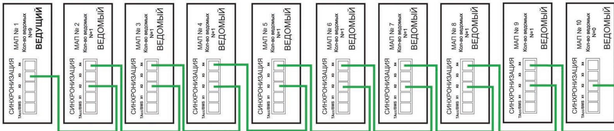
Все приборы подключаются к одному массиву АКБ. Входы переменного тока 220/230В всех МАПов в системе должны быть подключены к одному источнику входного напряжения (также с соблюдением фазы и нуля). На рисунке 8 представлена схема подключения МАП при параллельном подключении в однофазной сети.
