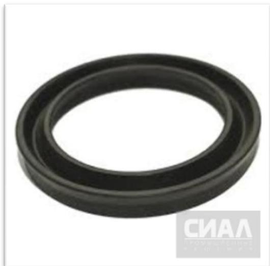
Манжеты гидравлические предназначены для уплотнения зазора между цилиндром и поршнем (плунжером, штоком) в гидравлических устройствах. В этом разделе представлен размерный ряд поставляемых гидравлических манжет согласно ГОСТ 14896-84, ГОСТ 6969-54. Производство происходит методом точения, диаметром до 1 метра.
