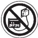
Подсоединение электростанции к электросистеме здания должно осуществляться только квалифицированным электриком и должно соответствовать всем электротехническим правилам и нормам. Неправильное подсоединение к системе может стать причиной выхода из строя электрогенератора, неисправности электросети и подключенных к ней электроприборов, а также привести к поражению электричеством людей.
