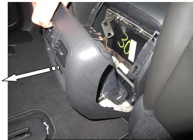
Снять заднюю крышку
