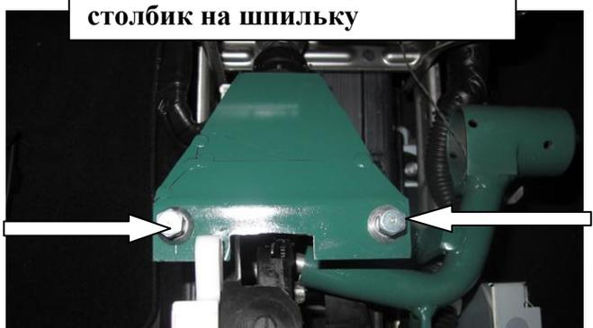
Установить замок короткой лапкой на второй шестигранный столбик и защиту на третий шестигранный столбик и короткую лапку замка, закрутить 2 срывных болта
