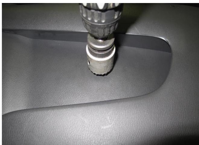
Разметить с помощью разметочного шаблона, просверлить и расширить до 32 мм. отверстие в консоли под корпус замка
