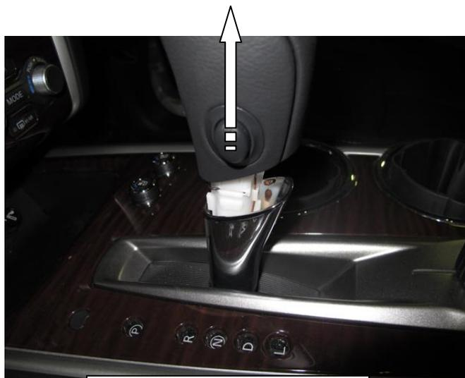
1 Снять рукоятку рычага переключения передач
