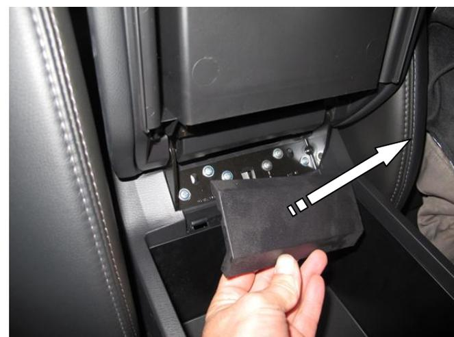
6 Поднять подлокотник, снять крышку
