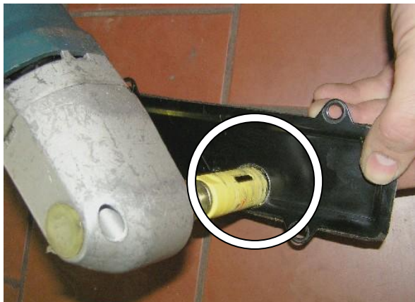
Просверлить отверстие под трубу замка в детали
