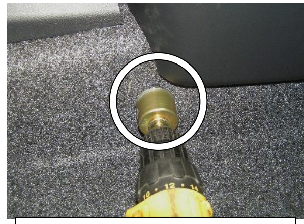
Просверлить отверстие под корпус замка в ковролине внутри салона
