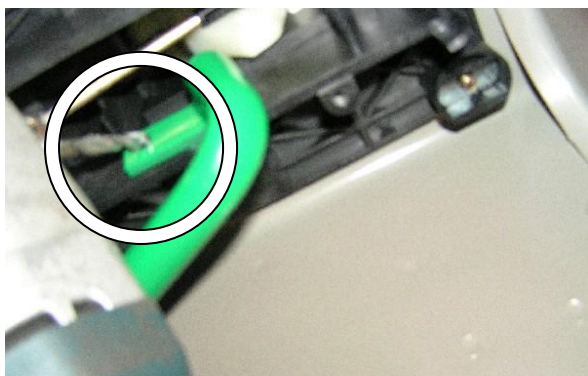
Установить деталь на место, закрутить 4 самореза, установить замок, просверлить отверстие в детали через отверстие в лапке замка
