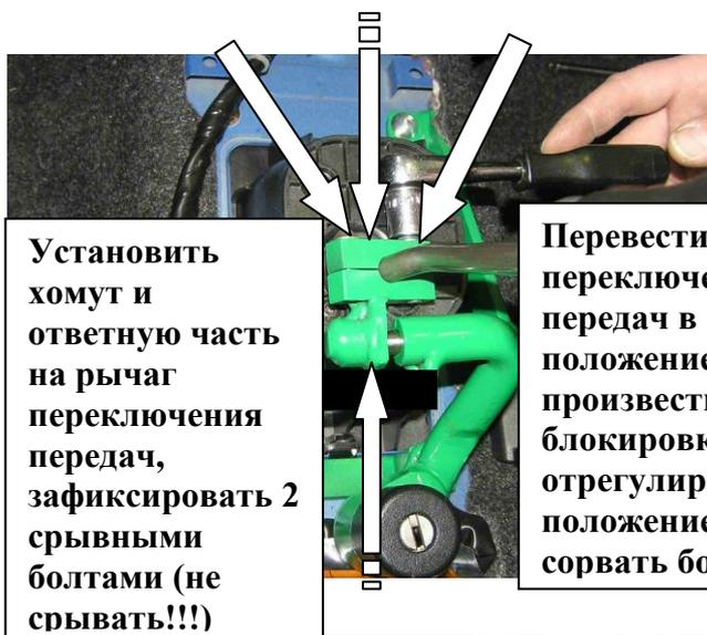
Установить хомут и ответную часть на рычаг переключения передач, зафиксировать 2 срывными болтами (не срывать!!!)
