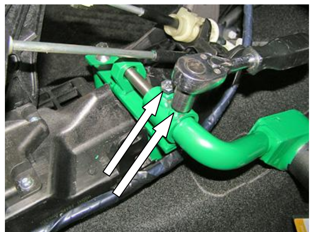
Зафиксировать трубу замка в кольце кронштейна 2 винтами
