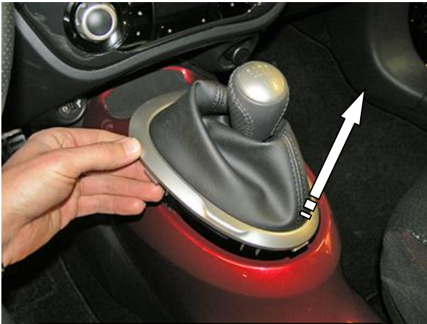
Снять декоративный чехол рычага переключения передач
