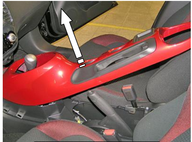
Снять верхнюю крышку
