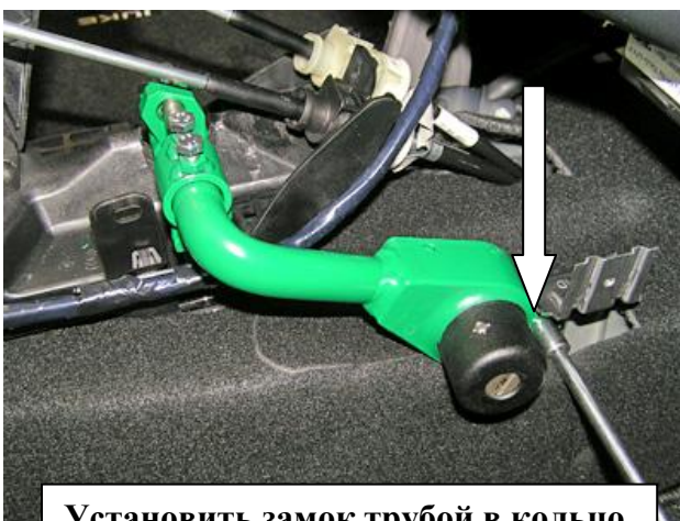
Установить замок трубой в кольцо кронштейна, зафиксировать лапку замка срывной гайкой
