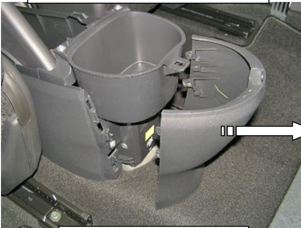
Снять заднюю крышку
