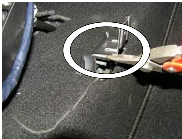
Удалить металл, мешающий установке замка
