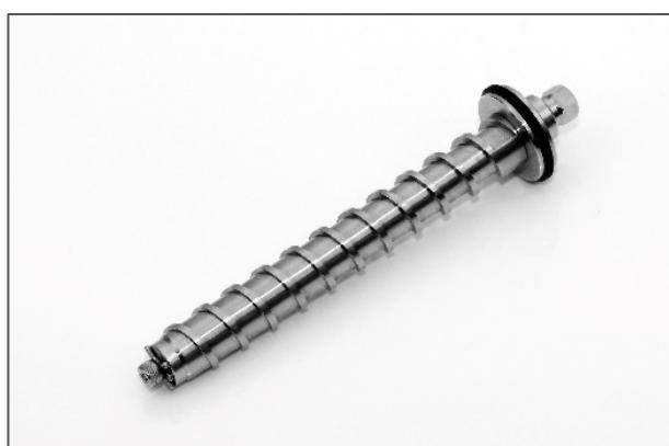
Дополнительный шнек с винтом, оптимизированный для более мелких семян (обозначен красным уплотнительным кольцом) особенно подходит для твердого продукта для прессования с мелкими зернами. Из-за более маленького винта транспортируется меньшее количество семян. Так обеспечивается оптимальная выжимка при более низкой температуре и сниженной потребляемой мощности мотора.
