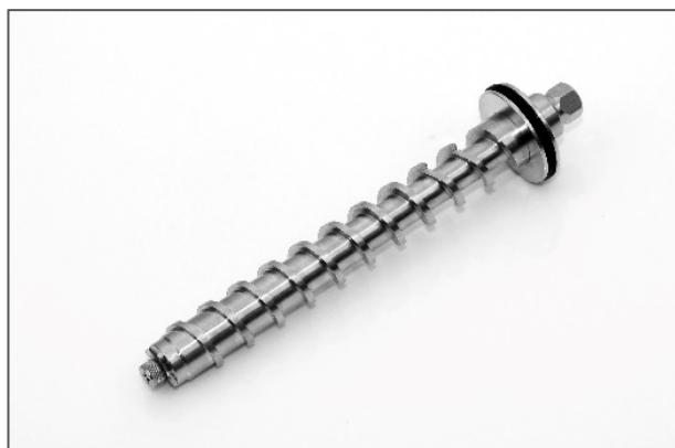
Стандартный шнек (обозначен черным уплотнительным кольцом) подходит для всех масличных семян, зерен и орехов. Благодаря особой форме винта в начале шнека продукт для прессования измельчается и непрерывно перерабатывается.
