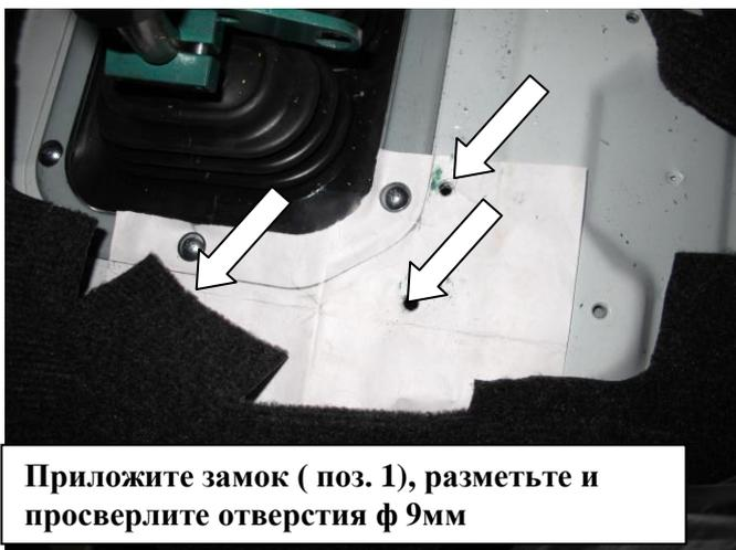
Приложите замок (поз. 1), разметьте и просверлите отверстия ф 9мм
