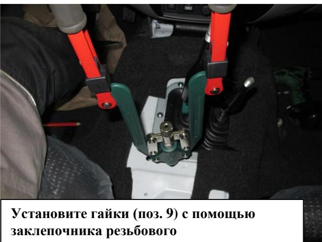
Установите гайки (поз. 9) с помощью заклепочника резьбового
