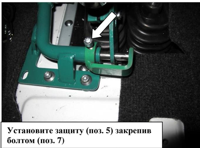
Установите защиту (поз. 5) закрепив болтом (поз. 7)
