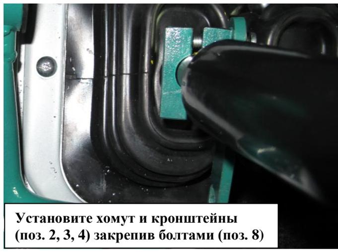
Установите хомут и кронштейны (поз. 2, 3, 4) закрепив болтами (поз. 8)
