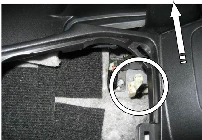
Разъединить разъём, снять заднюю консоль
