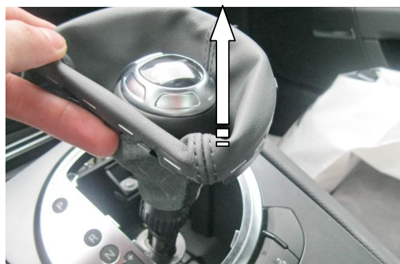
Снять декоративный чехол рычага переключения передач
